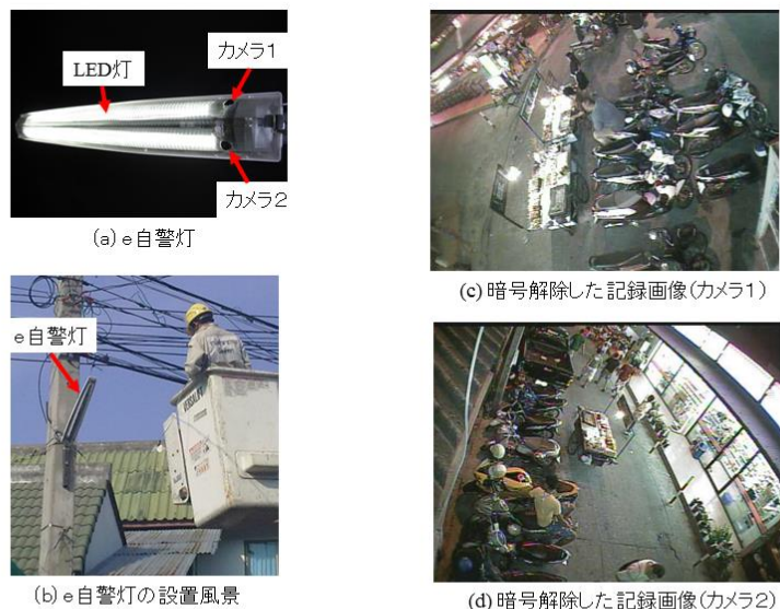
図4 e自警灯：e自警カメラ（2台）を内蔵したLED街路灯
