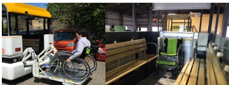
図3 車いすリフト使用時の様子と車内での車いすの固定位置(eCOM-10)
